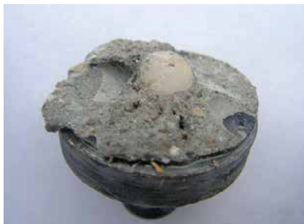
Tapadó-húzó szilárdság mérés megfelelő szakadási képére példa
