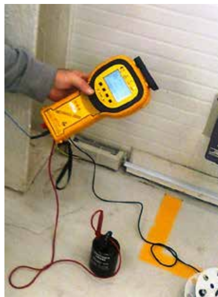
Nagy pontosságú digitális, memóriás levezetési ellenállást mérő műszer
